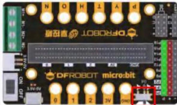
图 1.3.1 蜂鸣器开关打开示意图
